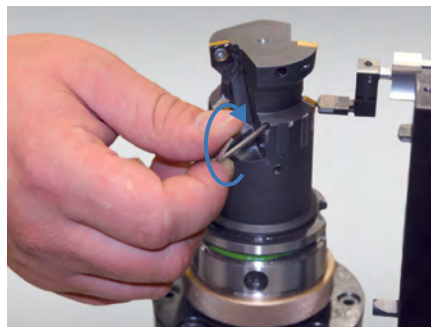
9. 六角レンチで調整ねじを時計回りに回して、インサートのオーバーハング(ガイドパッドに対するブレードセット値)寸法またはアブソリュート寸法を調整します。
