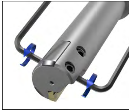
2. クランピングプレートを緩める: クランピングスクリューを両側から2~3回転左に回します(インサートは下向き)。
